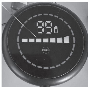
Niveau de puissance d'aspiration 2 – Niveau de puissance d'aspiration élevé
