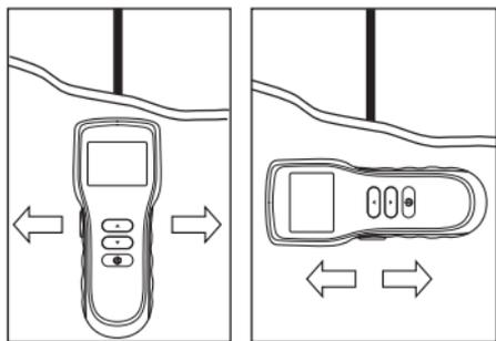
Bei der Ortung von elektrischen Leitungen Gerät um 90° drehen und noch einmal messen.
