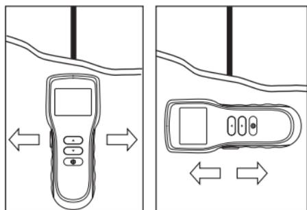
Pour localiser des câbles électriques, faire pivoter l'appareil à 90° et effectuer une nouvelle mesure.
