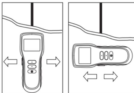
Draai bij het lokaliseren van elektrische leidingen het apparaat 90° en meet opnieuw.
